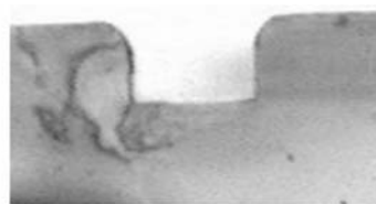
图5 注射成型微流控芯片的微沟槽横截面
